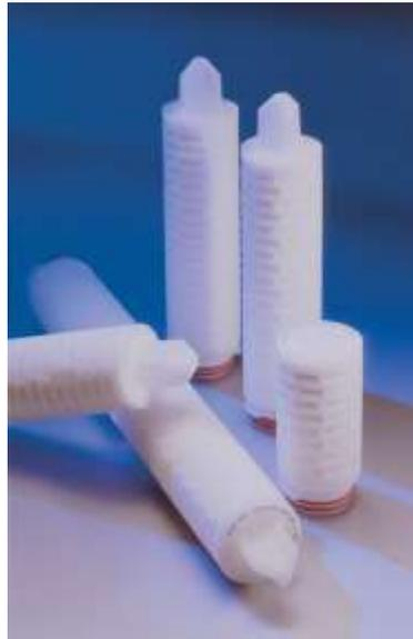
非対称タイプポリエーテルサルフォンメンブレンを搭載している為、高流量、低圧損となります。非対称膜の特徴として、フィルター膜表面のみならず内部での粒子捕捉も可能ですので、捕捉容量が大きくロングライフとなります。特に粒度分布の広い流体のろ過に最適です。素材は極めて低溶出の為、食品、医薬のアプリケーションにも安心してご使用頂けます。
